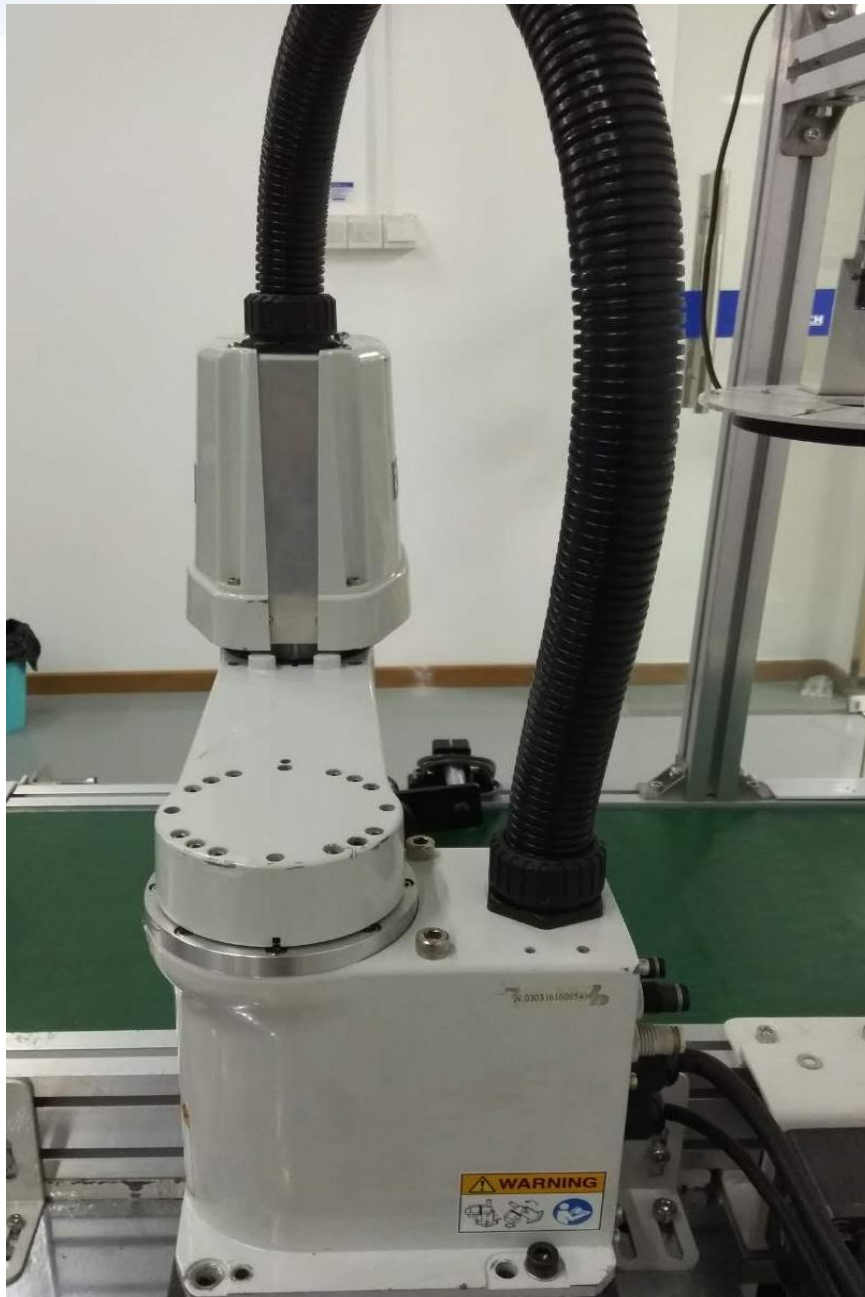
机器人各轴原点位置侧视图
